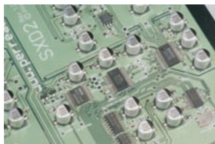
▲ AK4117VF接收轉為數位訊號後由src4193作升頻，BB PCM1738E作DA處理。
