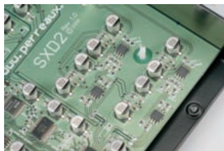
▲類比電路裝載BB 2134 OPA作訊號放大輸出。
